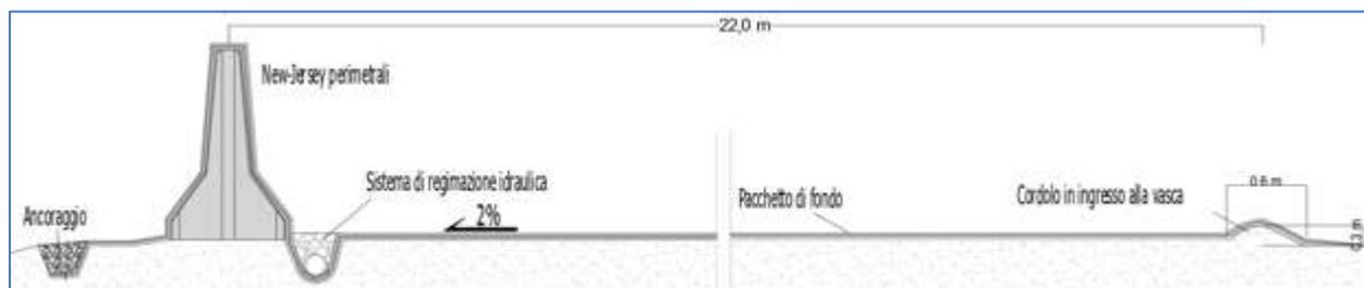
Figura 14 - Sezione trasversale della vasca di deposito.
