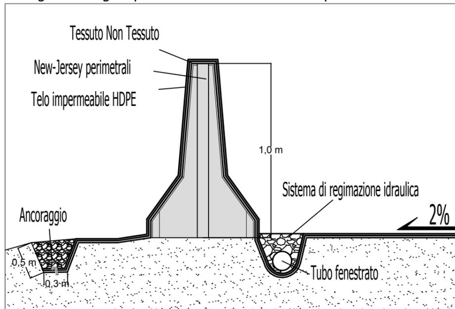
Sezione trasversale di una baia di stoccaggio
